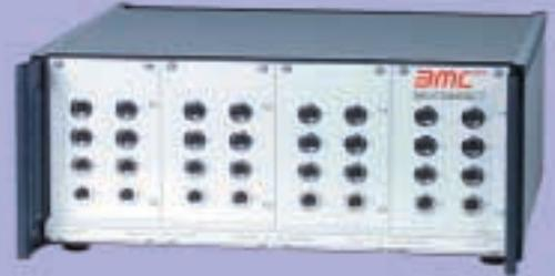
Verstärkerrack für 32 Meßkanäle, bestückbar mit 5B-Modulen oder Direktschaltung. 32 Sensor-Anschlußbuchsen 5-polig (Binder). 2 Ausgangsbuchsen 37-polig (Sub-D) auf der Rückseite. Netzteil extern
