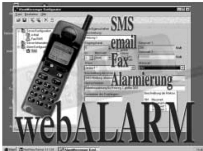
webALARM vergleicht kontinuierlich die von der Sensorik eingehenden Werte mit den festgelegten Grenzwerten. Es läuft im Hintergrund parallel zur Meßdatenerfassungssoftware Next-View®/NT. Nach einem Alarm steht der exakte Zeitverlauf für die Fehleranalyse im System zur Verfügung. So kann man schnell die Ursachen für eine Grenzwertüberschreitung erkennen.
