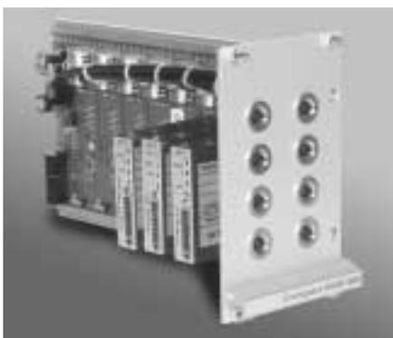
Verstärkereinschub und galvanische Trennung mit acht 5B-kompatible Verstärkermodule
