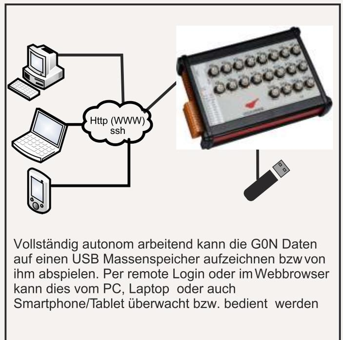
Vollständig autonom arbeitend kann die G0N Daten auf einen USB Massenspeicher aufzeichnen bzw von ihm abspielen. Per remote Login oder im Webbrowser kann dies vom PC, Laptop oder auch Smartphone/Tablet überwacht bzw. bedient werden
