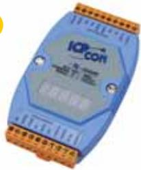
Das **I-7080** ist ein Zähler-/Frequenzmodul und verfügt über zwei unabhängige 32 Bit Zähler.
