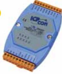
Das **I-7065** verfügt über 4 galvanisch getrennte Eingänge und 5 Relaisausgänge mit hoher Schaltleistung, mit denen unter anderem Netzspannung bis zu 5 A Leistung direkt geschaltet werden kann.
