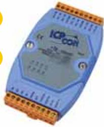
Das **I-7060** hat 4 galvanisch getrennte Digitaleingänge und 4 Relaisausgänge, je zwei des Typs A und C. Das **I-7060D** verfügt zusätzlich über eine LED-Statusanzeige. Die digitalen Eingänge können bei dieser Version auch als Zähler benutzt werden.
