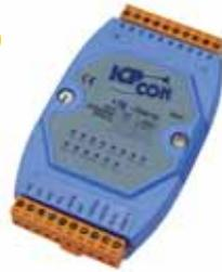
Das **I-7041** besitzt 14 galvanisch getrennte Digitaleingänge. Das **I-7041D** verfügt zusätzlich über eine LED-Statusanzeige. Die digitalen Eingänge können bei dieser Version auch als Zähler benutzt werden.
