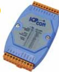
Das **I-7018P** entspricht dem I-7018, hat jedoch einen erweiterten Messbereich für Thermoelementtypen.
