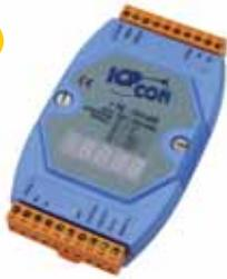
Das **I-7014D** hat einen galvanisch getrennten Differenzeingang für Spannung und Strom. Es ist mit einem LED-Display ausgestattet, das den aktuellen Messwert und Hi/Low-Alarmüberschreitungen anzeigt.
