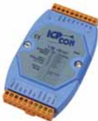
Das **I-7016P** ist bezüglich Messbereich, Auflösung, Messgeschwindigkeit und der digital E/A-Kanäle mit dem I-7016 identisch. Es verfügt jedoch nur über einen Analogeingang für DMS, der jedoch mit einer Fühlerleitung für die Stromversorgung der DMS-Brückenschaltung ausgestattet ist.
