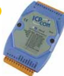
Das **I-7015** verfügt über 6 Differenzeingänge mit Stromspeisung für Temperaturmessungen mit Pt-, NI- und CU-Widerstandsthermometer. Die Eingänge sind gegen den RS-485 Bus galvanisch getrennt.
