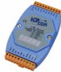
Das **I-7016** verfügt über zwei Eingänge für den Anschluss von Dehnmessstreifen, einen Ausgang für Spannungen von 0 bis 10 V, vier Digitalausgänge und einen Digitaleingang. Die analogen Eingänge sind gegen den RS-485 Bus galvanisch getrennt.
