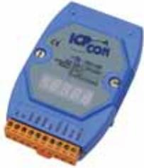
Das **I-7011** verfügt über einen galvanisch getrennten Differenzeingang für Spannung, Strom und Thermoelemente, Klemmstellenkompensation für Thermoelemente und über einen digitalen Eingang, zwei digitale Ausgänge und das **I-7011D** über ein 4½-stelliges Display.
