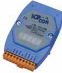
Das **I-7011P** entspricht dem I-7011, hat jedoch einen erweiterten Messbereich für Thermoelementtypen. Das **I-7011PD** verfügt zusätzlich über ein 4½-stelliges Display.
