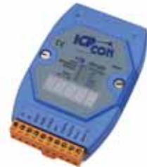
Das **I-7012** besitzt einen galvanisch getrennten Differenzeingang für Spannung und Strom, einen digitalen Eingang und zwei digitale Ausgänge. Das **I-7012D** verfügt zusätzlich über ein 4½-stelliges Display.
