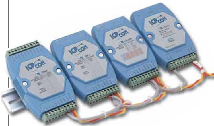
Die **ICPCON-Serie** besteht aus **kompakten, robusten und intelligenten Sensor to Computer Interfaces** für verteilte Anwendungen in der Messwerterfassung und Prozesssteuerung.
