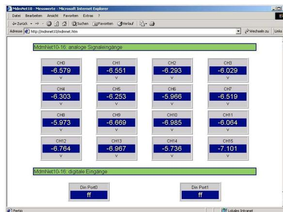
Das Treiberkonzept für das MdmNet10 umgeht die asynchrone Datenübergabe in einem Netzwerk durch einen optimierten zyklischen Datenaustausch zwischen dem PC und dem MessModul. Die Zykluszeit ist in einem Bereich von 20 .. 1000msec einstellbar. Der Standardwert beträgt 25msec. Der Datenaustausch ist während der gesamten Messdauer, unabhängig von der eingestellten Messrate, aktiv.
