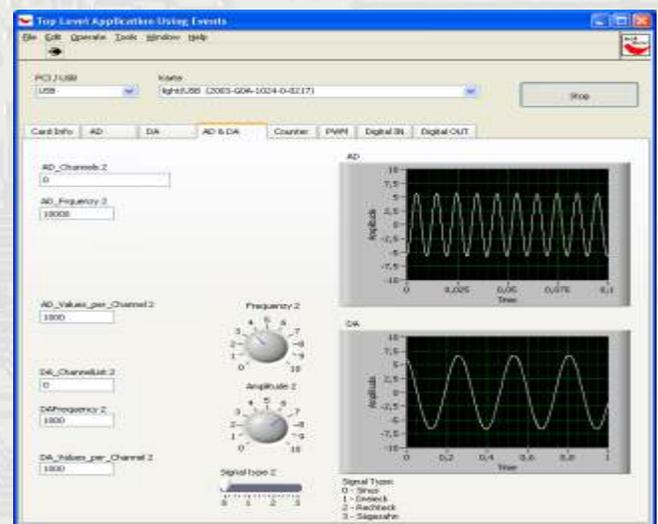
In dem kostenlosen Softwarepaket der Goldammer MC4 PCI und USB Messkarten wird ein graphisches einfach bedienbares Messprogramm „Mc4Measurement“ angeboten. Das Programm bietet die Möglichkeit einer schnellen und unkomplizierten Messung mit den Messkarten unseres Hauses durchzuführen. Nach dem Start des Messprogramms werden alle auf dem System installierten Messkarten erkannt und dem Anwender zur Auswahl zur Verfügung gestellt.
