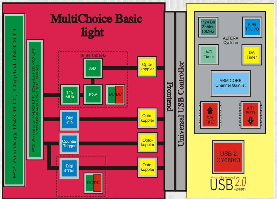
digitalen Ein-/Ausgängen eine Vielzahl an Signalen, die in einem synchronen Modus zeitgleich erfasst werden können, um eine exakte zeitliche Zuordnung der Messwerte verschiedener Signalarten untereinander zu gewährleisten. Eine asynchrone Erfassung ist ebenfalls möglich.
